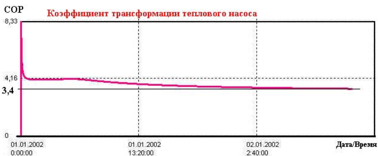
Рис. 10.3. График изменения COP от старта теплового насоса до стационарного состояния при T_n=-20^{\circ}\text{C}
